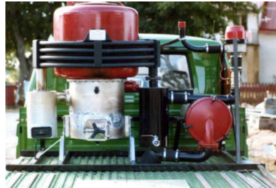
Abb. 2 und 3: Holzkohle-Gasgenerator auf VW Pritschenwagen (Schweden 1981)
