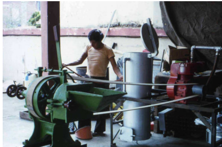
Abb.12: Versuch der Kommerzialisierung: Holzkohlevergaser zum Antrieb einer Maismühle (Guatemala 1986)
