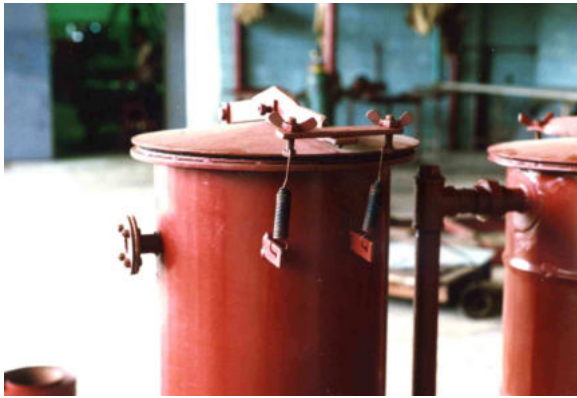
Abb. 22: Verschlussdeckel eines Generatorkessels (Cali, Kolumbien 1990)
