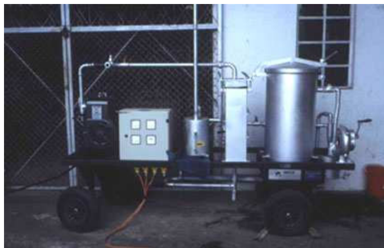
Abb. 9: Prototyp des Gasgenerators beim Probelauf in Buenaventura, Kolumbien. Ganz rechts das Anfachgebläse, links der Motor.
