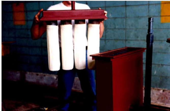
Abb. 25 und 26: Die Filterbeutel der Gasreinigung
