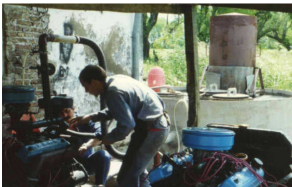
Abb.13 und 14: Gewerbliche Nutzung eines Holzvergaser in Ferrozement-Bauweise zum Antrieb des Motors einer Sägemühle, Leistung 20 kW (Argentinien 1992)
