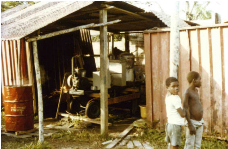
Abb.10: Holzkohle-Gasgenerator im Instituto Matia Mulumba (Buenaventura, Kolumbien). Links im Bild die Tonne, in der die Holzkohle durch die Motorabgase getrocknet wird.
