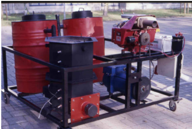
Abb. 20 und 21: Holzkohle-Gasgenerator mit sechseckigem Generator-kessel, ca. 8 kW Motorleistung (Universität Bremen, 1992)
