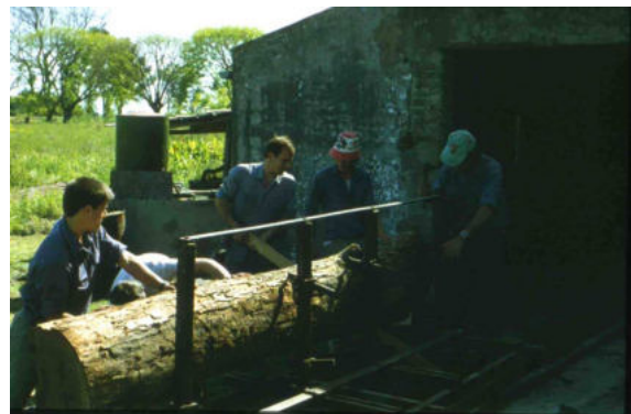
Abb.13 und 14: Gewerbliche Nutzung eines Holzvergaser in Ferrozement-Bauweise zum Antrieb des Motors einer Sägemühle, Leistung 20 kW (Argentinien 1992)
