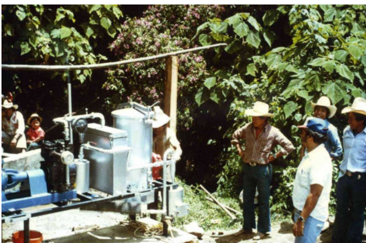
Abb. 4: Holzkohle-Gasgenerator mit Wasserpumpe, Motorleistung 2 kW (Guatemala 1985)
