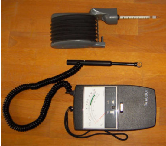
Abb.30: Pumpe mit Messröhrchen (oben) und Hitzdraht-Messinstrument
