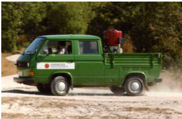
Abb. 2 und 3: Holzkohle-Gasgenerator auf VW Pritschenwagen (Schweden 1981)
