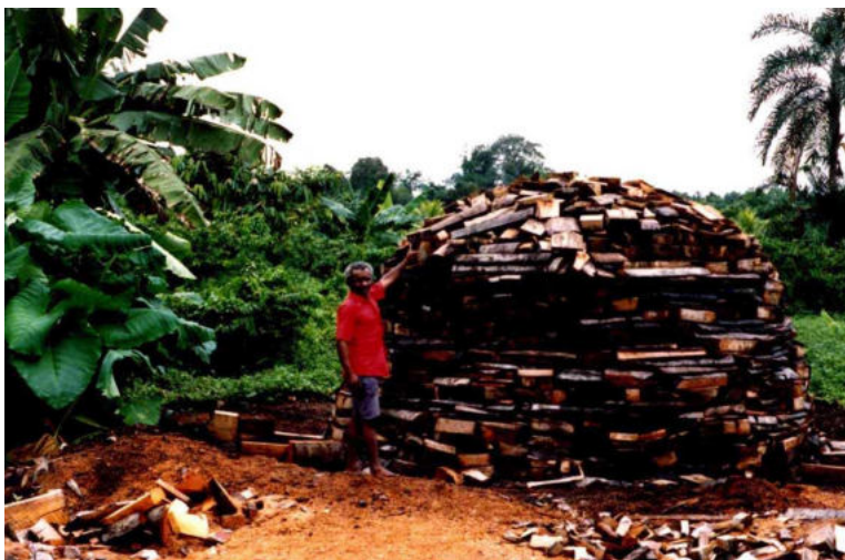
Abb. 8: Holzkohlemeiler in St. Cruz. Vor Inbetriebnahme wird der Meiler mit feuchtem Sägemehl bedeckt.
